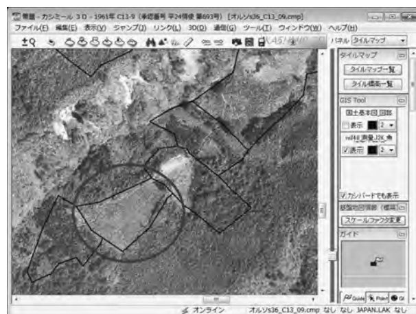
図-6 1961年撮影のオルソ写真 (測量結果のポリゴンあり)
