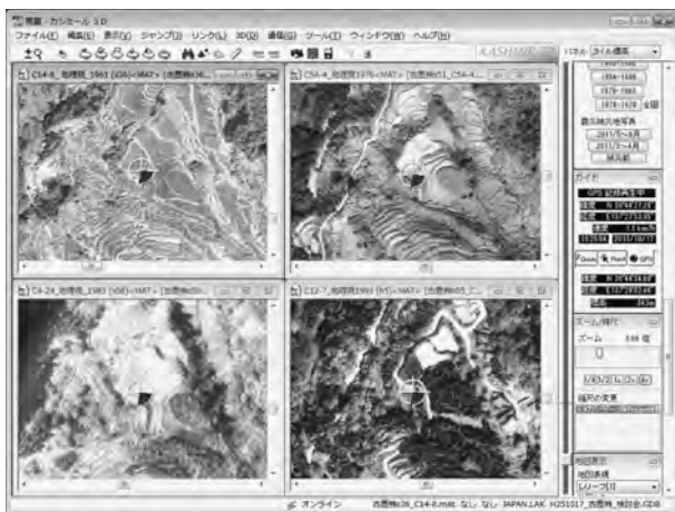
図-2 ノート PC での現地ナビゲーション中の画面 （カシミール 3D で 4 時期のオルソ写真を表示）
