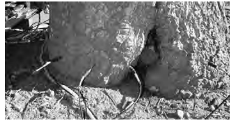
図-2 音響波による腐朽診断の様子(センサー、上)と診断画面(左)色は見かけの音速(凡例の上端 1500 ~ 下端 250 m/秒)
