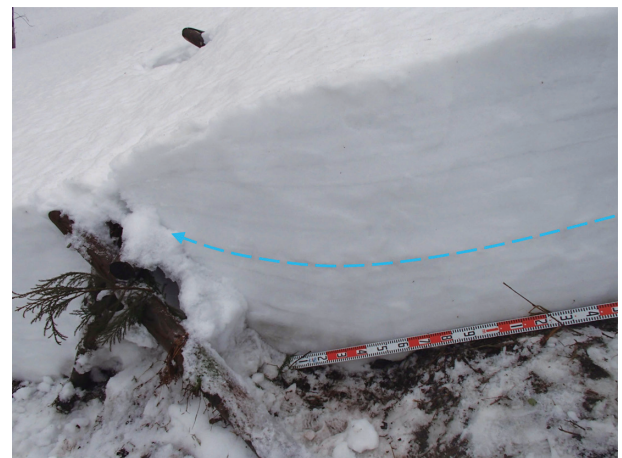
写真-5 積雪断面で筋状にみえる複数の線が予防杭の位置で褶曲している (青点線はそのイメージ)
