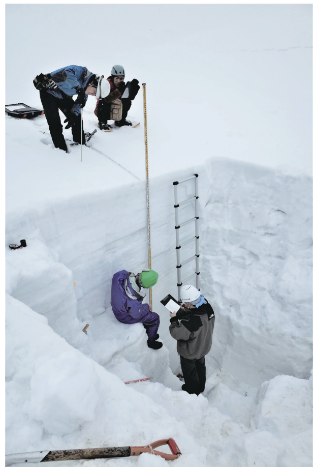
図-1 新潟県の山間地における積雪調査のようす。深さ約 4 m の積雪断面を切り出し、雪質や密度などの諸性質を細かく調べている。
