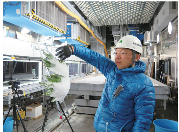
写真-2 風洞装置により人為的に発生させた湿雪の着雪 風洞装置を風速 9 \text{ m/s} で稼働した状態で、装置上部から湿雪を供給して、スギ枝に衝突させることで、人為的に着雪を発生させた。着雪体は、手で軽く引っ張る程度の力では破損しないほど、硬く緻密であった。また、一定の方向から雪を供給した結果、着雪体は風上側に突き出た三角形状をしていた。
