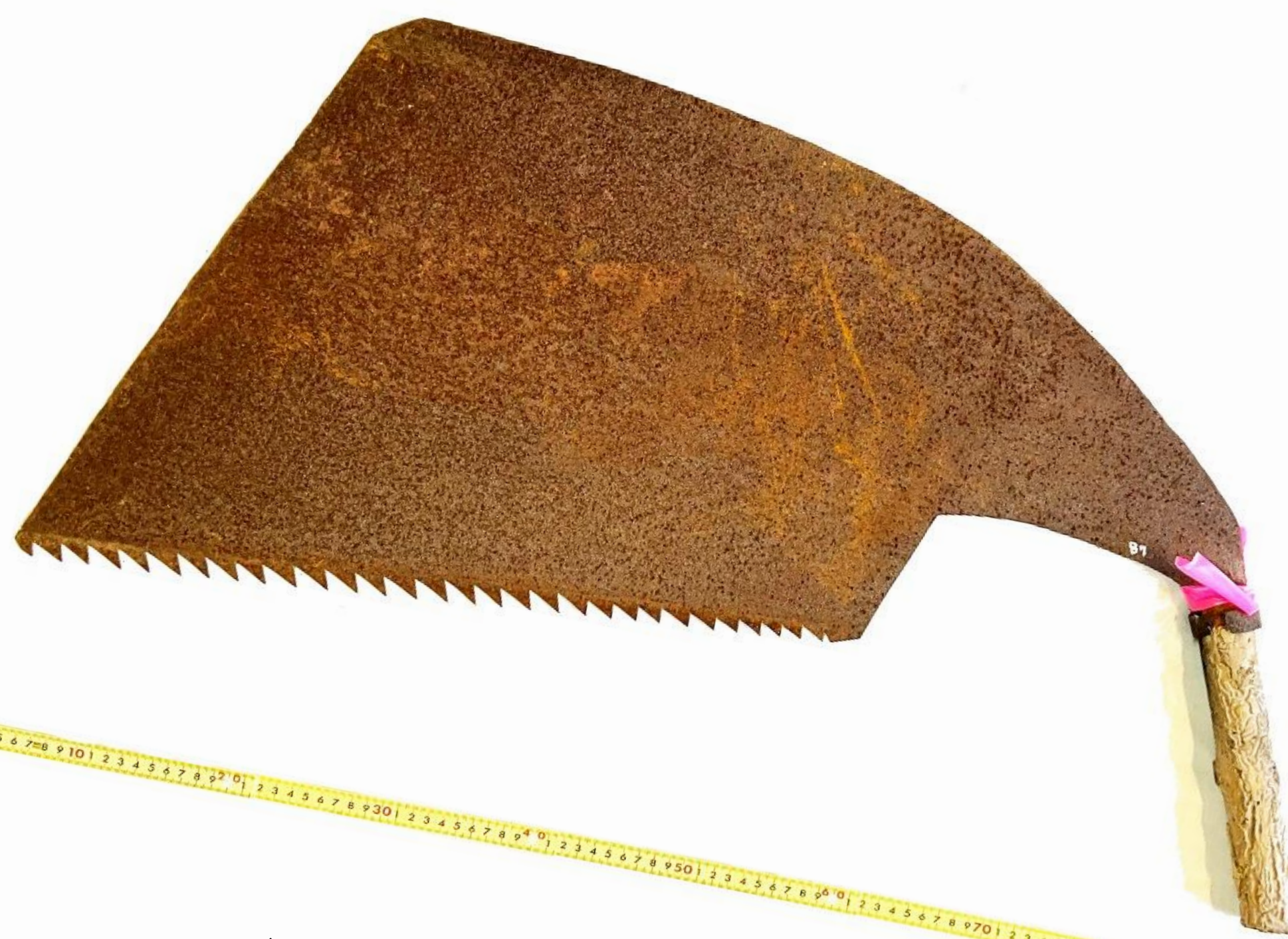
マエビキノコ（資料No. 87） 木材を縦に挽くときに使われた大型のノコギリ。 刃渡り55.7cm。
