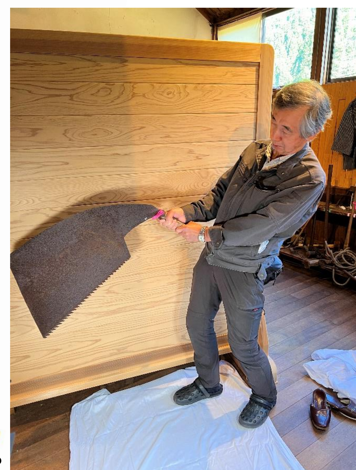
マエビキノコ（資料No. 87） 木材を縦に挽くときに使われた大型のノコギリ。 刃渡り55.7cm。
