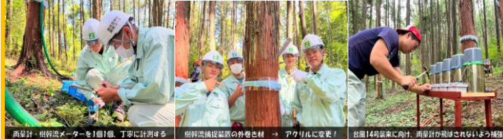
雨量計・樹幹流メーターを1個1個、丁寧に計測する 樹幹流観測装置の巻巻き材 → アクリルに変更！ 台風14号襲来に向け、高木計測が難しいよう種強
