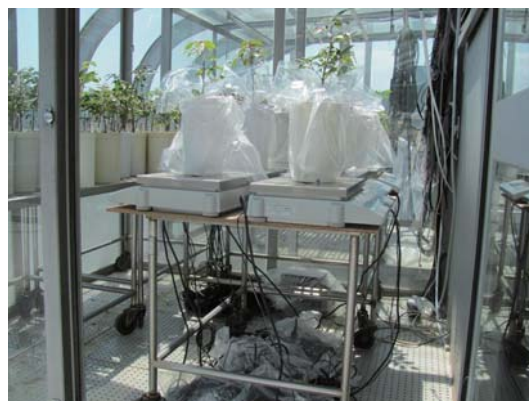
写真-3 上皿天秤を用いた重量法での蒸散速度の計測
