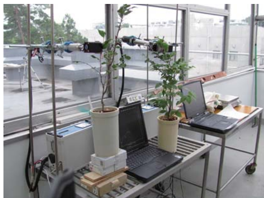
写真-2 光合成蒸散測定装置 (CIRAS-1) を用いた純光合成速度の計測
