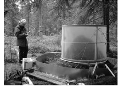
写真-1 アリ塚チャンバーによるアリの巣からのCO 2 放出量の測定
